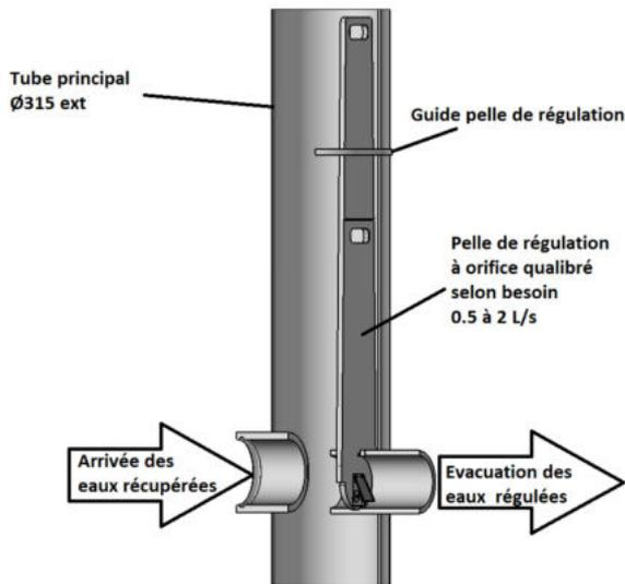
Les eaux pluviales, après passage dans le bassin en SAUL (structure alvéolaire ultra-légère) et la décantation dans le fond du regard, passent par un orifice calibré qui limite le débit (à déterminer en fonction de la surface imperméabilisée et le volume du bassin, pour assurer un débit de 3 L/S / Hectare). Un clapet intégré évite les remontés du réseau aval.
